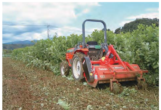
写真6 フレールモアーによるクロタラリアの細断
