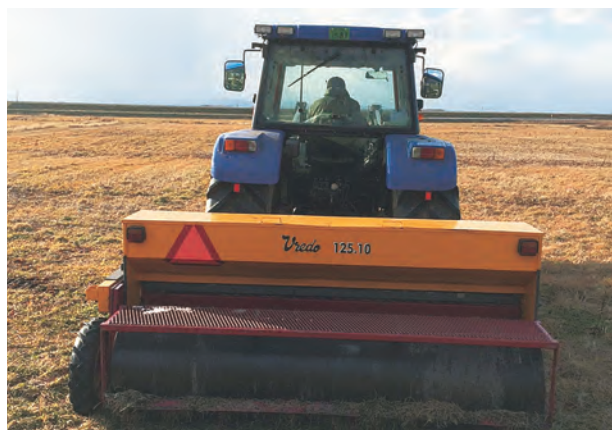
写真3 作溝型播種機「ブレド・オーバーシーダー」
