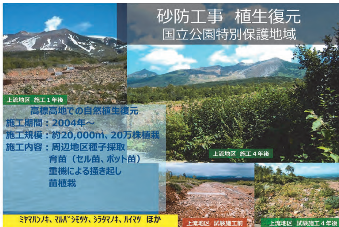
写真1 砂防工事跡地での植生復元
