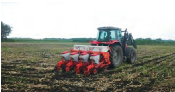
写真2 不耕起播種機による二期作目の播種作業
