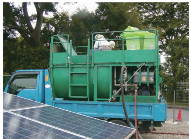
写真2 専用の吹付け機械
