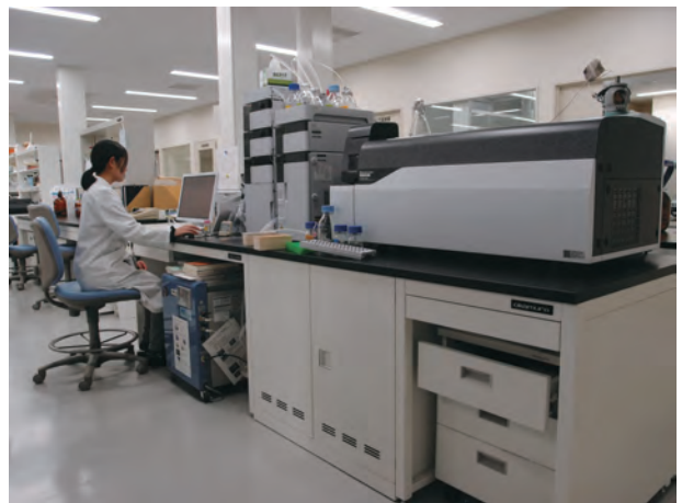
写真1 北海道研究農場新研究棟に導入した液体クロマトグラフ質量分析計
