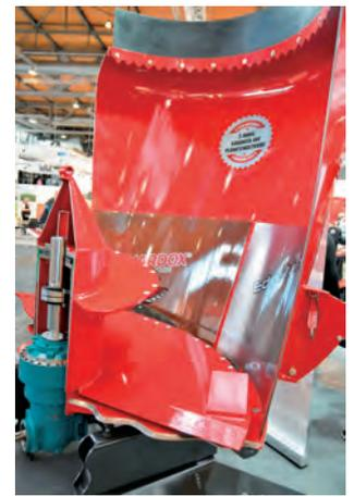
写真5 カッティング付き縦型ミキサーの断面
