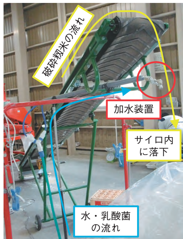
写真２ 当時の破碎粳米への加水方法。破碎後の粳米をベルトコンベアでライン輸送し、破碎粳米がサイロ内へ落下するタイミングで加水。
