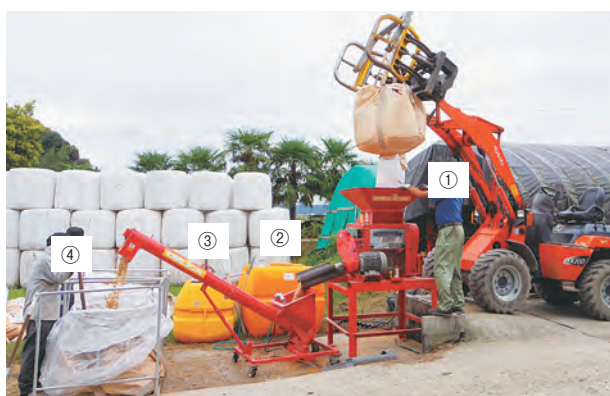
写真3 宮崎県内の繁殖農家における粃米サイレージ調製の実例。①フレコンバック内の原料粃米を破砕機に投入②スクリュウコンベアの投入口に加水装置を設置③破砕後にスクリュウコンベアで水・乳酸菌・破砕粃米を撈拌しながら輸送④均一に混合された破砕粃米をサイロ口に投入する。
