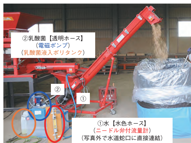
写真5 水と乳酸菌混合液を2流路でそれぞれ添加する事例
