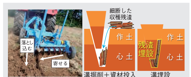
図2 カットソイラーの機構図 (株式会社 北海コーキのサイトより引用)
