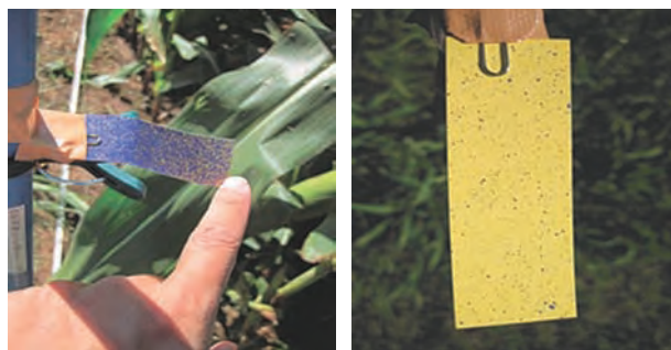
写真4 ドローン散布によるドリフトの確認 （左：散布地点、右：散布地点から2m地点）
