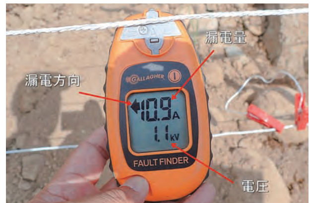
写真10 漏電探知テスター フォルトファインダー
