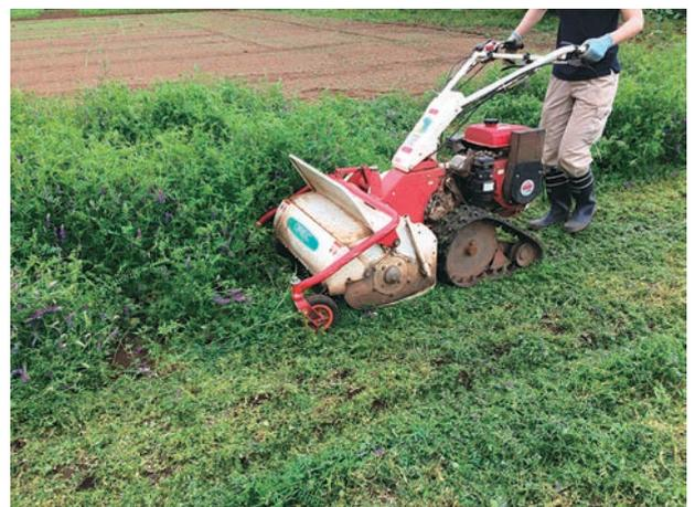
写真7 ハンマーモアによるヘアリーベッチの細断
