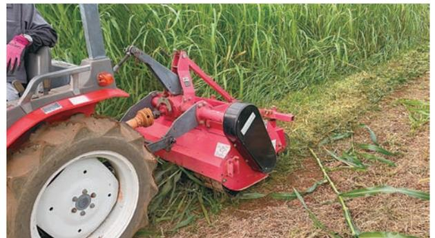
写真6 フレールモアによるパールミレットの細断
