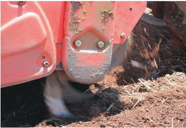
写真3 浅いロータリー耕起による覆土
