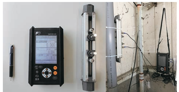
写真1 超音波水量計（左）と設置例（右）
