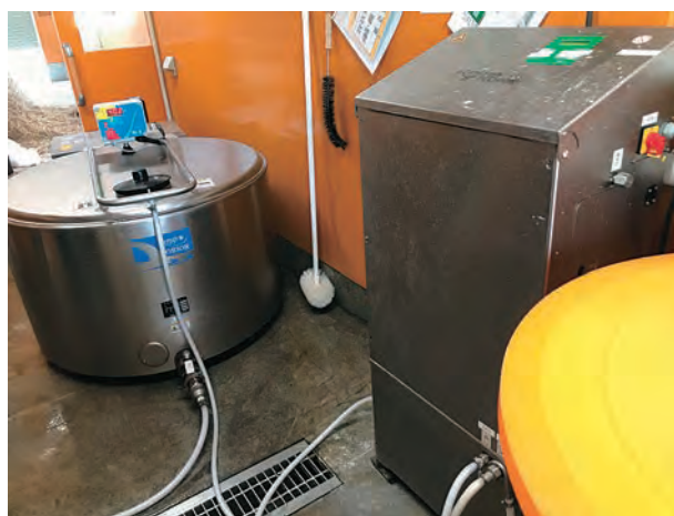
写真2 現地農家での哺乳ロボットでの生乳給与の様子 (写真は群飼設備での導入事例) 左側が生乳を入れるタンク、右は移行乳用パスチャライザー
