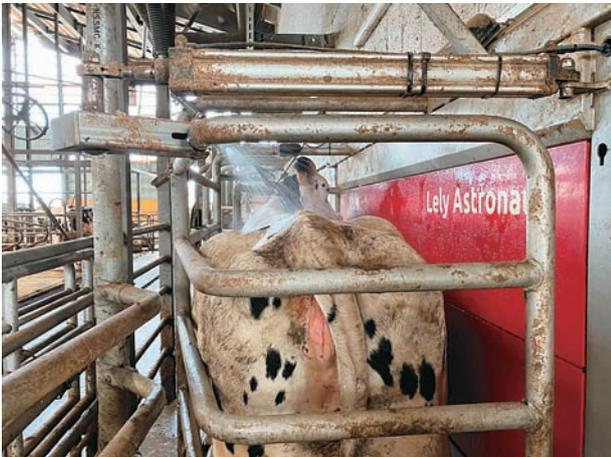
写真4 搾乳ロボット内でのソーカーシステム
