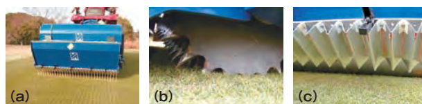
写真5 スリット&シーダー1000（株式会社MKヤブタ製）によるインターシード (a) 作業の様子 (b) スパイク部 (c) シーダー部
