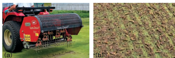
写真4 パーチドレイン7212 (Redexim) によるコアリング (a) 作業の様子 (b) コアリング後の芝の様子
