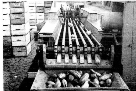
工場前の広場でガーキンを大きさによって自動選別しているところ 小さいものは途中で隙間から下方に落下するが大きいものは最後迄落ちないで手前の受器に入る 大きいものは喜ばれない 小さいものの方が値も高いのである 右側に積重ねてある函は農家から持込まれたガーキンの入った函である
