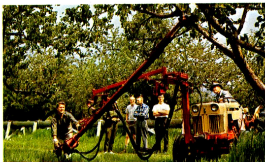
③ シューカー式摘果機の試験風景
