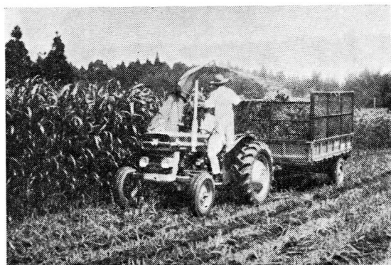
フレール型ハーベスターによる刈り取り作業
