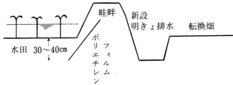
図3 畦畔からの漏水防止
