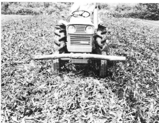
耕耘幅だけ押し倒すために耕耘機の前に押し倒棒をとりつける
