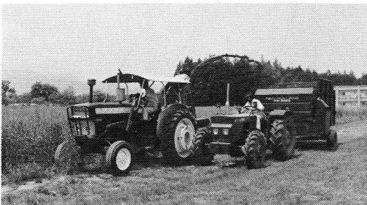
シリンダー型ハーベスタによるライムギの収穫作業
