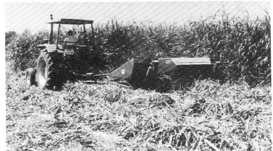
写真2 モーアコンディショナによる刈取風景 （千葉研究農場）
