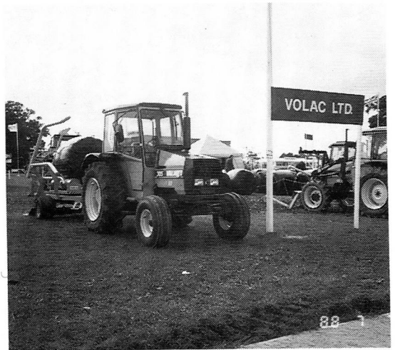
写真6 酪農機械のロイヤルショー（昨年7月）での展示の一例。この場所は1988年度に賞を与えられた農業機械の展示場所。写真はビッグボールをビニールシートで包み、サイレージ化する機械で昨年からこれが日本にも導入された。酪農の機械化は世界的な傾向で、乳牛頭数が増えても家族労働で飼育できるために、機械化はますます進む。労力を効率化するだけでなく、いやな、単調な仕事を機械に任せ、労力を牛を見るために多く使う。機械化はロボット化、すなわち無人化に向っており、コンピューターがそれに大きな役割を占めている。日本のパソコンが外国で広く使われているのに、日本の酪農機材が遅れているのはなぜだろうか。
