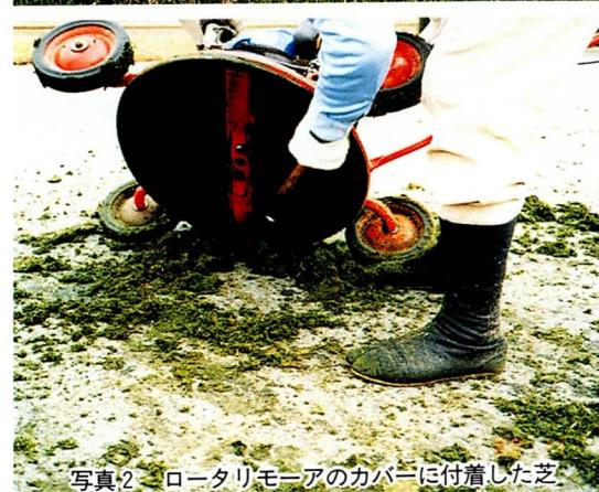
写真2 ロータリモーアのカバーに付着した芝
