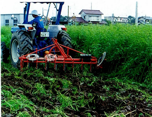
写真4 ディスクプラウによる田助すき込み切断、すき込みを同時に行うことができる
