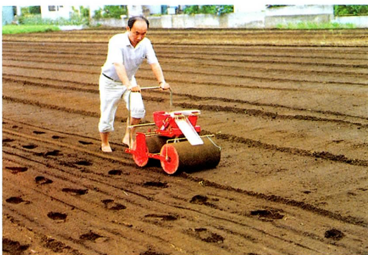
写真3 ごんべいによる播種作業 適水分条件での播種を心掛ける
