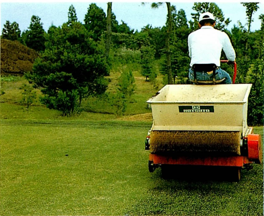
写真2 目土散布機による目土
