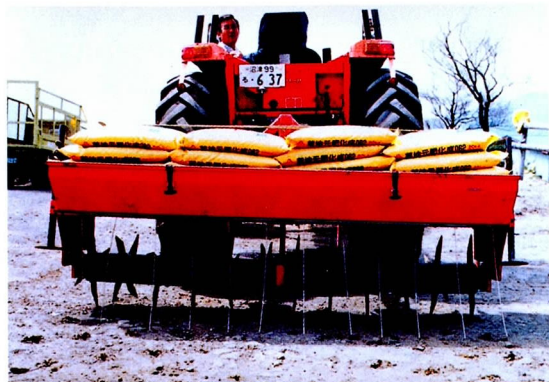
写真5 牧草簡易追播機(グランドホッグ) (肥料はウエイト代目で条件により加減する)
