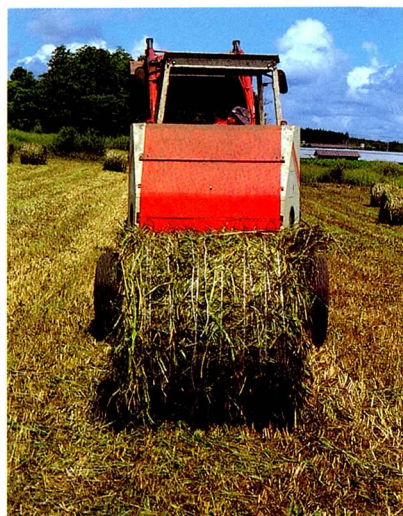
写真2 ロールベアラによるヘイスーダンの梱包
