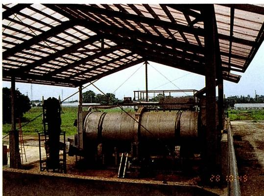
写真2 密封式ロータリーキルン堆肥発酵装置
