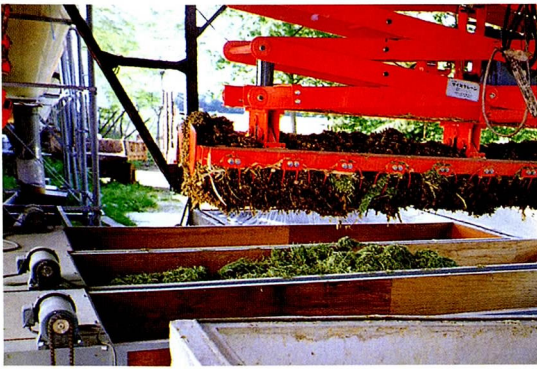
写真2 サイロクレーンでサイレージと切断乾草が荷受けコンベアに自動的に補給され、左側の飼料タンクから群ごとに必要量が混合される
