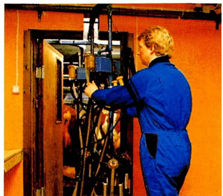
写真1 スウェーデンで開発されたユニット。レールで吊り下げてユニットを移動する
