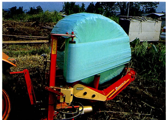
写真8 ペールラップによるラッピング
