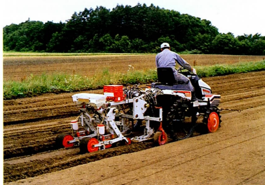
写真2 ペースト肥料の側条施肥播種機（ダイコン）
