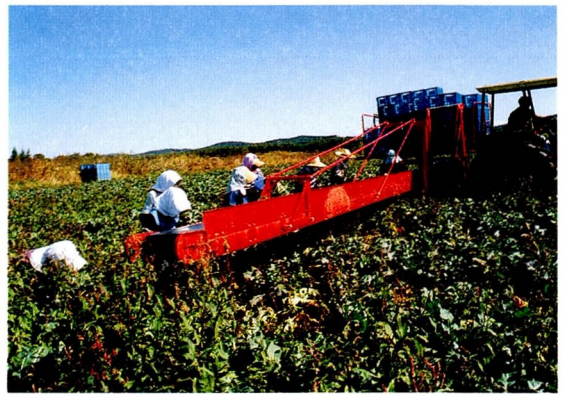
写真6 コンベヤキャリヤ方式（ブロッコリ）
