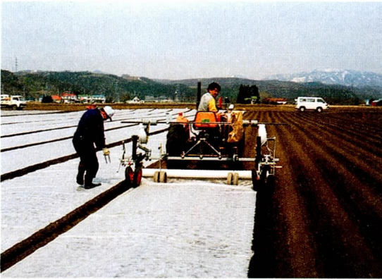
写真4 「べたがけ」資材の被覆作業機
