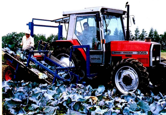
写真10 キャベツの一斉収穫機
