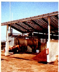
糞尿を短期間に有機質肥料に変える雪印堆肥発酵機「沃野」(本文20頁参照)
