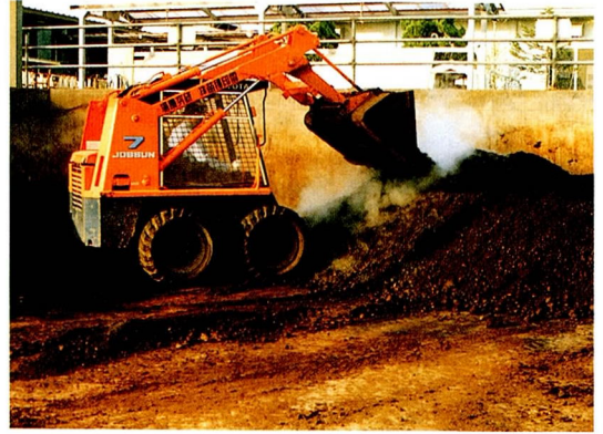
写真6 堆肥の切換えし
