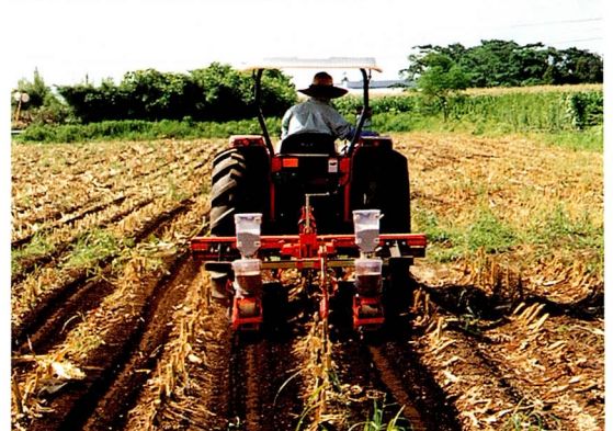
写真3 部分耕作業機による播種作業の状況 (8/3)
