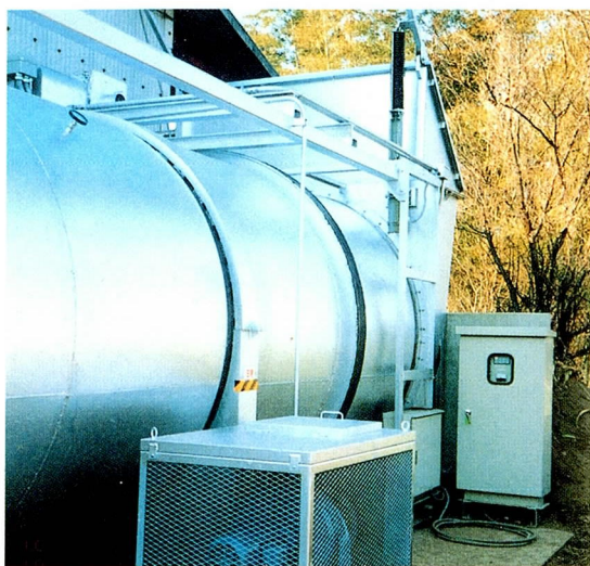
写真2 「沃野」の制御、駆動系
