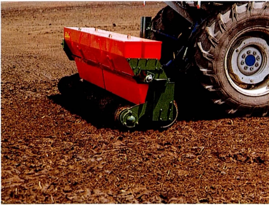
写真1 クラスシーダーによる播種作業 (適度な覆土が行われる)
