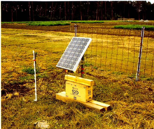
写真1 電気牧柵を使うための電気は、このような太陽電池を用いて発電します
