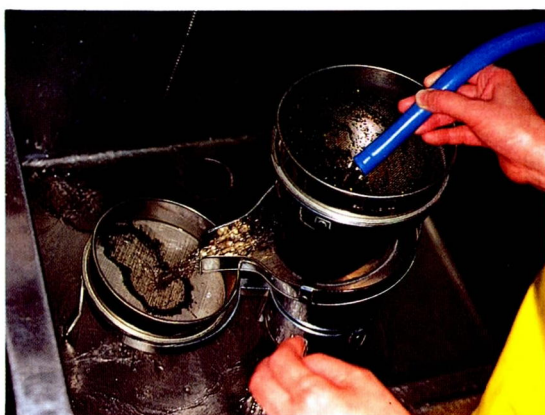
写真9 フェンウィック浮遊装置 (シストの分離方法)
