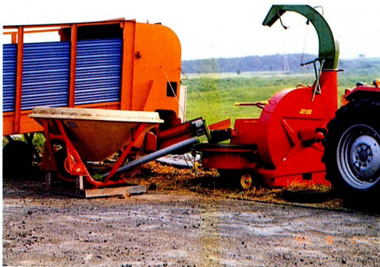
写真3 ブロードキャスタを変造した「連続混合装置」 (草地試, 瀬川氏考案)
