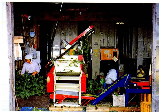
写真2 エダマメ専用莢もぎ機。効率化を図るためには4～5名が必要となる。
