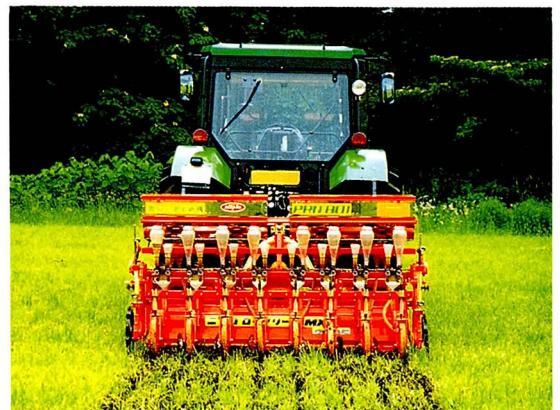
写真2 簡易草地更新機による作業風景
