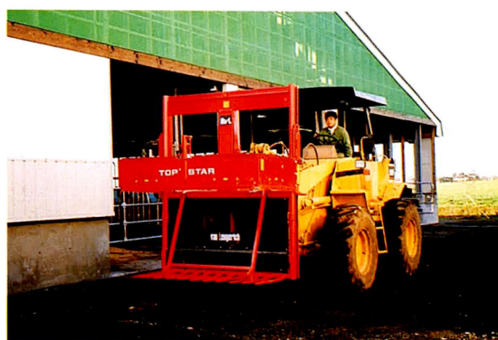
写真8 ホイールローダーへのサイレージカッター装着状態
