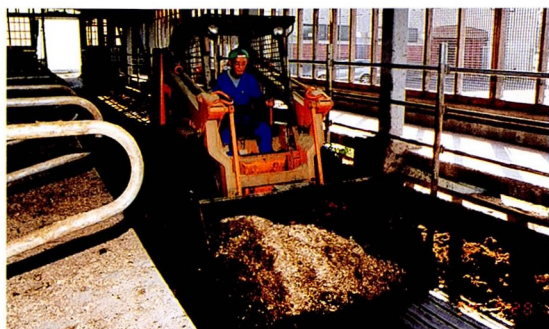
写真4 スキッドローダーによる除ふん作業
