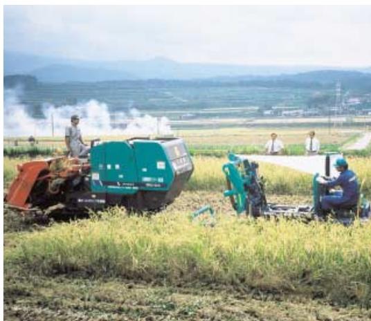
**写真1 ダイレクトカッティングロールベアラとラッピングマシン**
