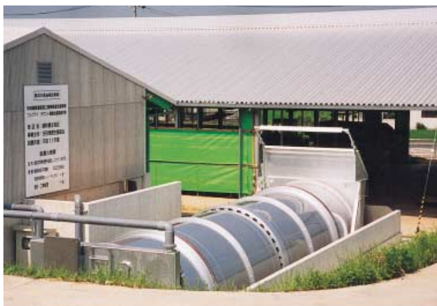
沃野 12A キル径3.0×長さ12m 処理容量59m 3 /7日
