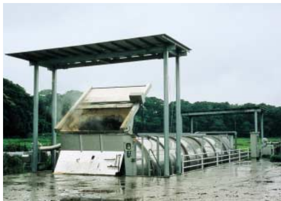
沃野20A タンク径3m×長20m 処理能力約100m 3 /7日
