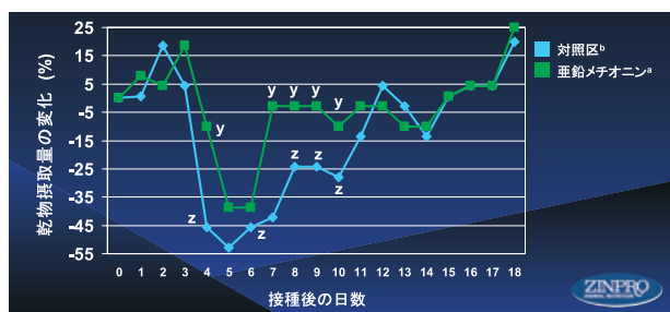
a ZINPRO® 亜鉛メチオニンを添加 飼料中亜鉛90mg/kg b 亜鉛無添加 飼料中亜鉛31mg/kg yz 同一日において異符号間に有意差あり ( P < 0.05 )
